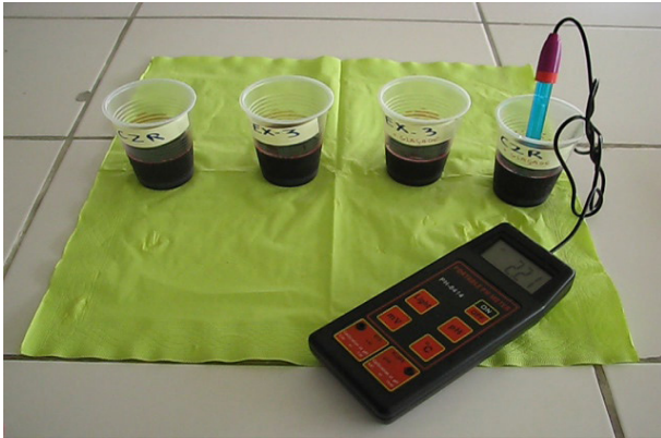
Figure 4 : Mesure du pH des bains après immersion des disques de céramiques
