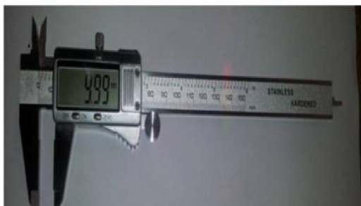
Figure 3: Pied à coulisse électronique (MITUTOYO CORPORATION)
