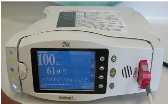
Figure 2 : l'oxymètre de pouls qui enregistre les valeurs de pouls et la saturation en oxygène
