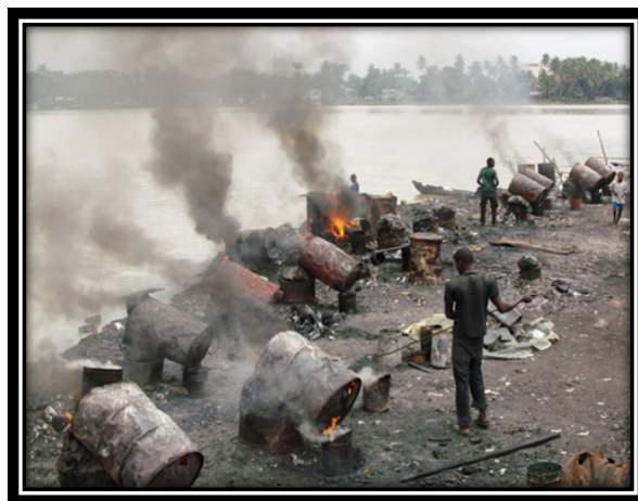
Photo 2 : Fontes de résidus (caoutchouc et produit pétrolier) servant à la fabrication du goudron au quartier Biafra et dont les eaux usées se retrouvent directement en lagune.
